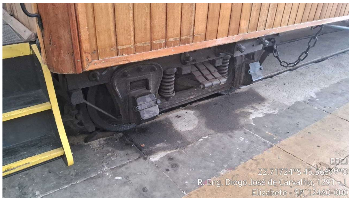
Figura 27 - Manchas de vazamento de óleo providos de truck do vagão de passageiros, por sobre piso com trincas - Pátio de Manutenção Capivari
