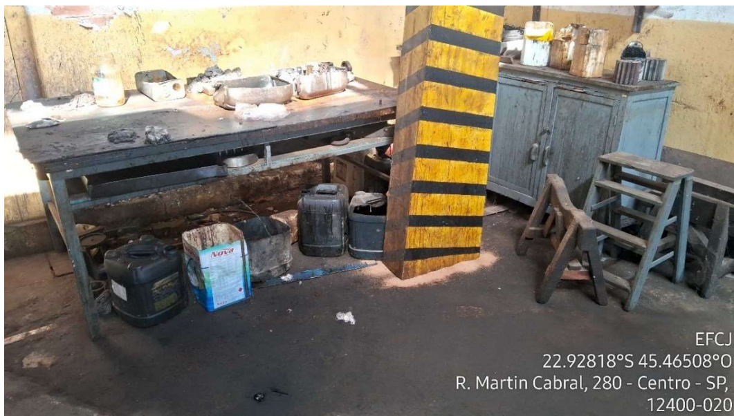
Figura 2 - Bancada de manutenção com óleo no piso - Pátio de Manutenção de Pindamonhangaba
