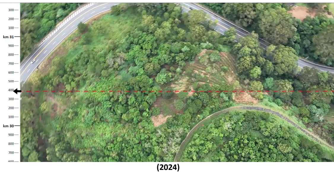
Figura 63 - Imagem aérea de drone - Erosão laminar em talude à jusante da via
