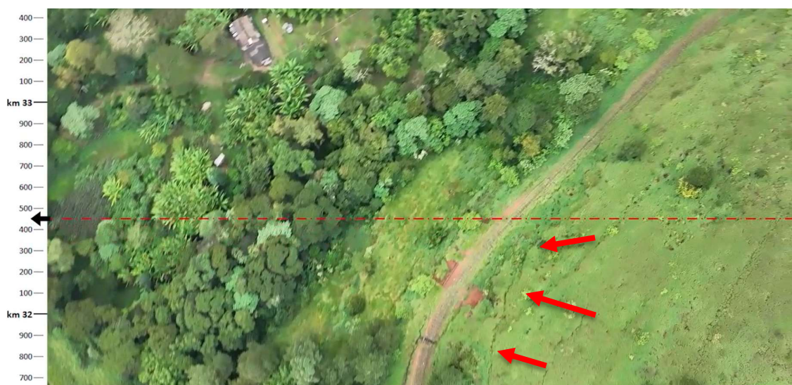
Figura 65 - Imagem aérea de drone - Processo erosivo em grande escala
