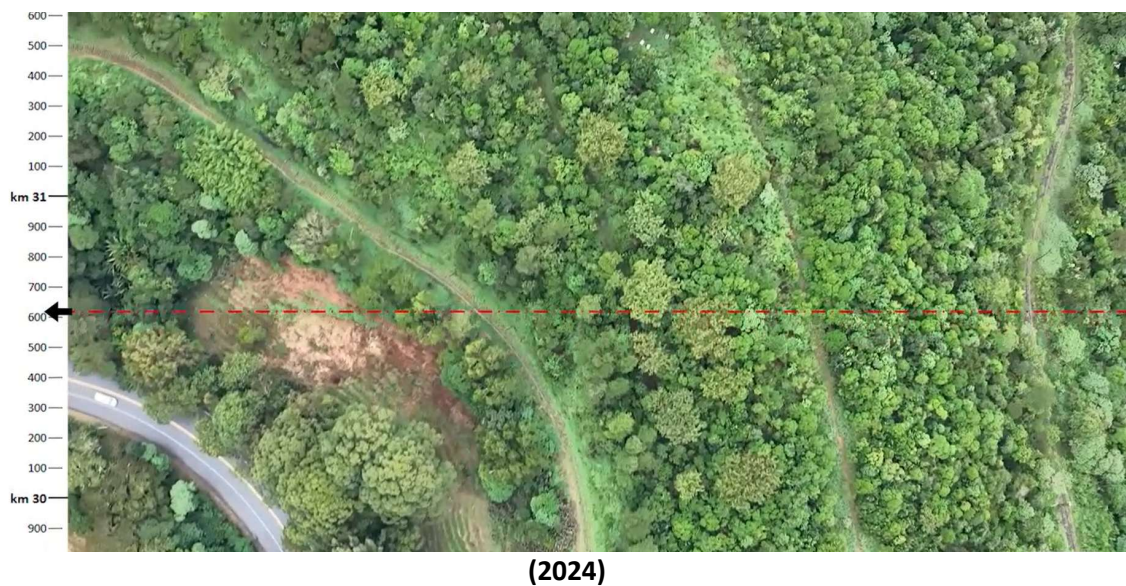
Figura 63 - Imagem aérea de drone - Erosão laminar em talude à jusante da via
